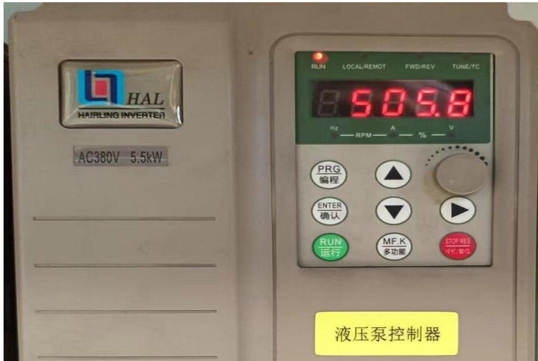
图 9. 电机转速显示
