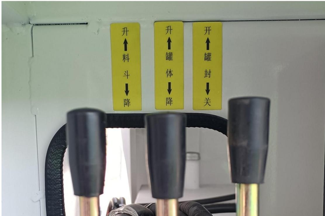
图11. 液压换向机构操作指引标识
