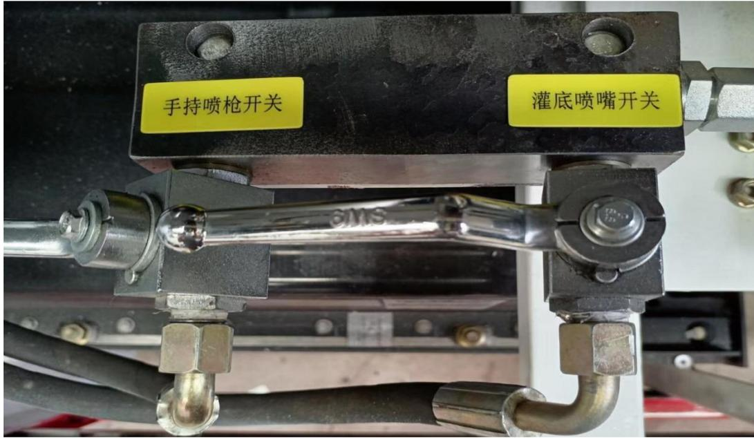
图13. 高压水功能开关指引标识
